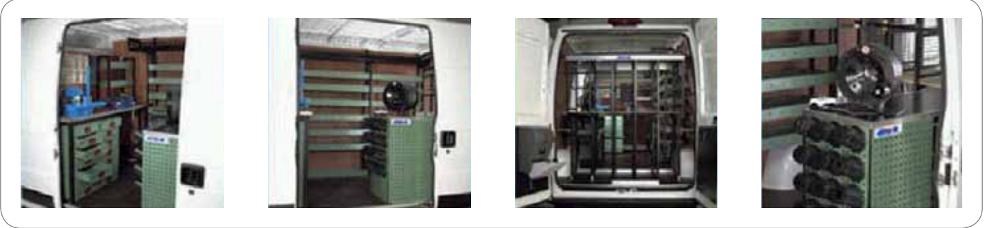
► Taller móvil para montaje de latiguillos | Atelier mobile pour montage des flexibles | Mobile workshop for hose assembly | Officina mobile per raccordatura tubi
